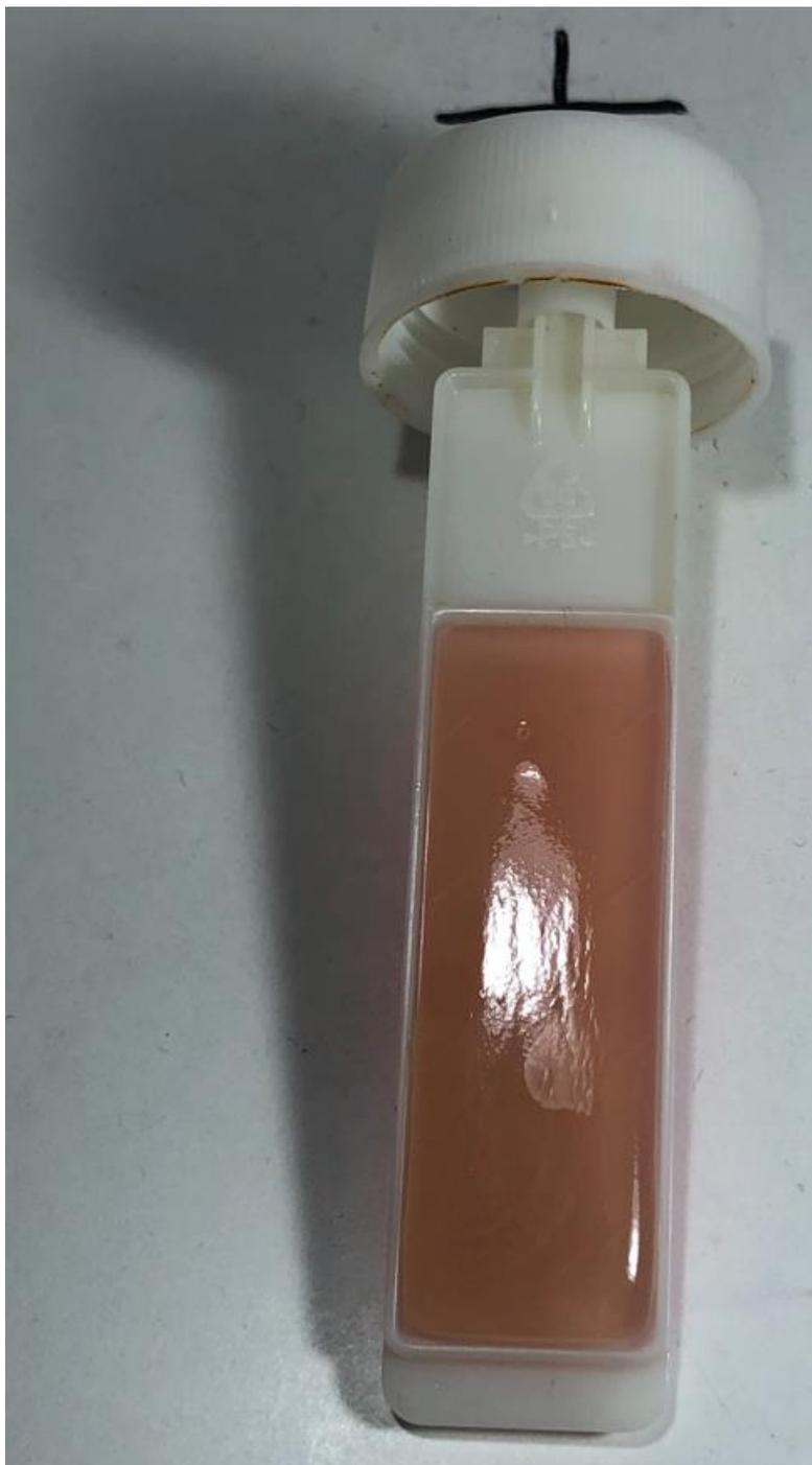
*Рис. 4. Фотография тест-слайда образца №1 для оценки общего количества бактерий.*
