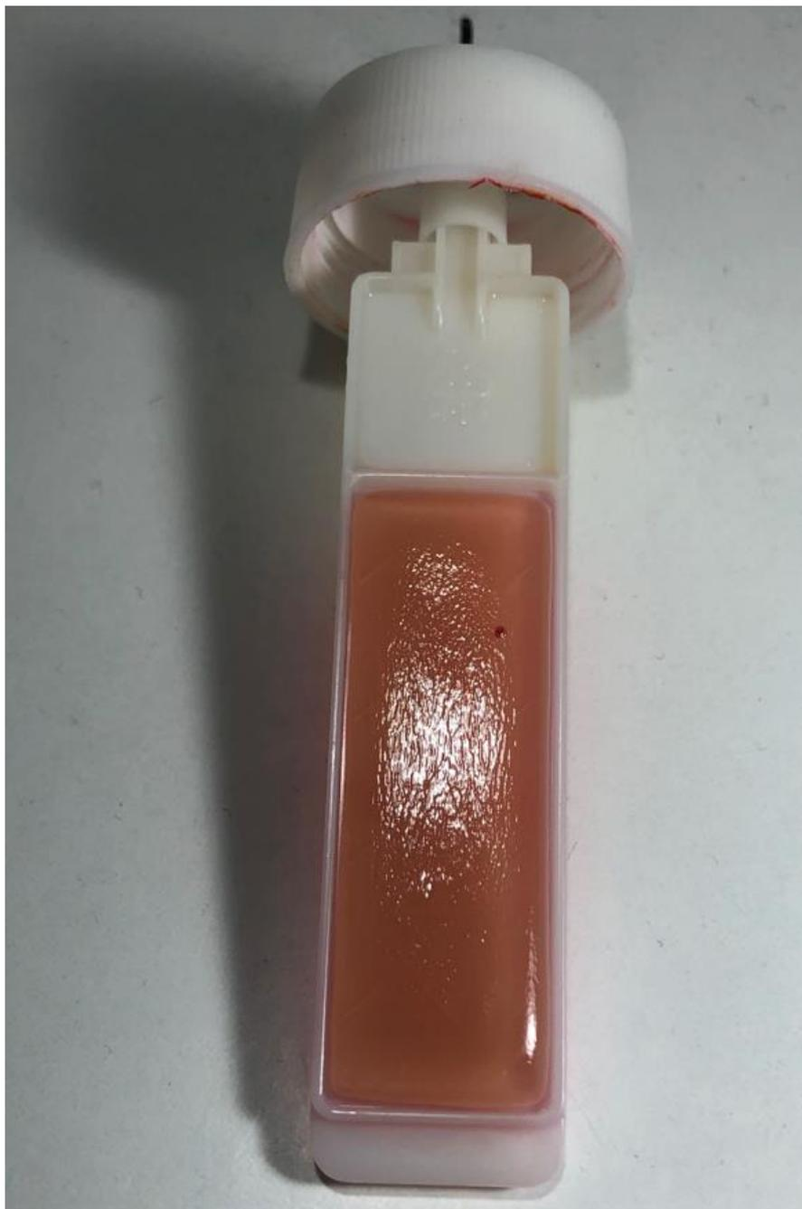
*Рис.3. Фотография тест-слайда образца №2 для оценки общего количества бактерий*
